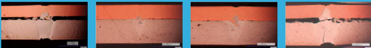
Das Laserschweißen von Kupfer zu Aluminium kann zu schwachen und spröden Verbindungen führen.
