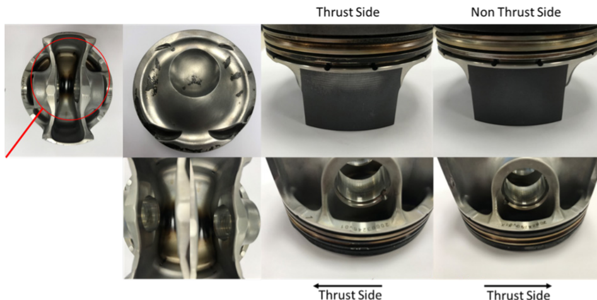
FIGUR 18 Zerlegter Kolben aus Zylinder I nach dem Langzeittest.
