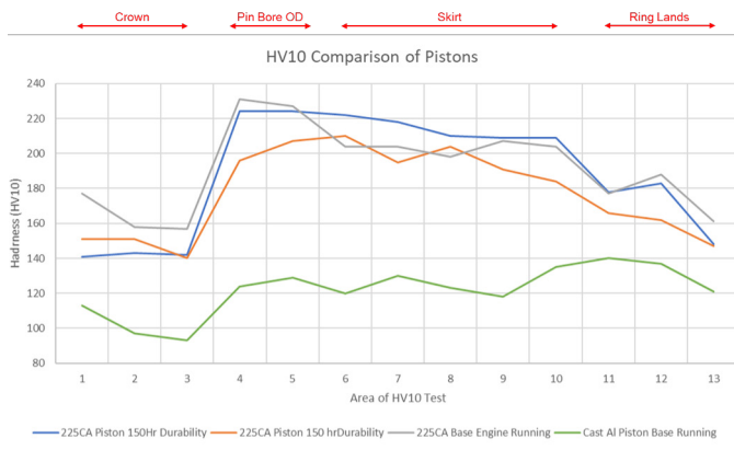
FIGUR 19 Härtemessungen (HV 10) nach dem Langzeittest an verschiedenen Messstellen (vgl. Figur 20).
