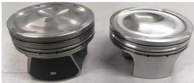
FIGUR 4: Modelle von OEM-Kolben und Materion-Kolben.
