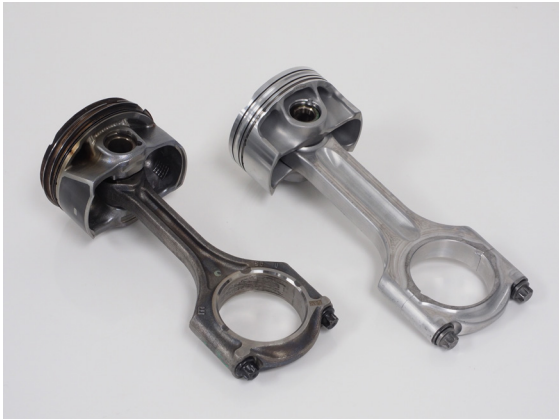
FIGUR 6: Links: OEM Zusammenbau von Kolben/Bolzen und Pleuel. Rechts: Materion Design von Kolben/Bolzen und Pleuel.
