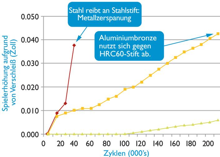
Oszillierende Bewegung über 45 Grad. Theoretische Lagerbelastung 2000 psi 13,78MPa. (Reale ist höher)
